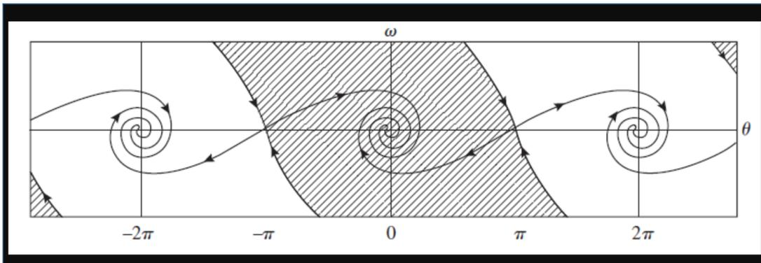
Figura 3: El retrato fase del péndulo no lineal consiste de puntos de equilibrio estables e inestables que se alternan; el estable corresponde al péndulo en reposo  $\theta = 0$  y el inestable al péndulo invertido  $\theta = \pi$ . Topológicamente las trayectorias están contenidas en un cilindro.
