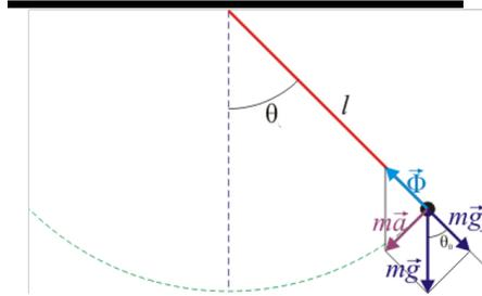
Figura 2: El péndulo consiste de una masa  $m$  que cuelga de una cuerda inextensible de longitud  $l$ , de tal manera que las únicas fuerzas que actúan sobre la masa son su peso, la fricción del aire y la tensión de la cuerda.
