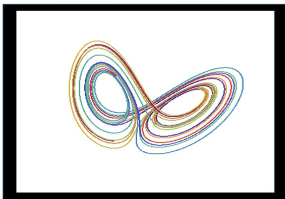
Figura 4: El célebre retrato fase del atractor de Lorenz parece una mariposa, en cuyas alas reposan los puntos fijos atractores del sistema. Las órbitas viajan de un ala a la otra caóticamente.
